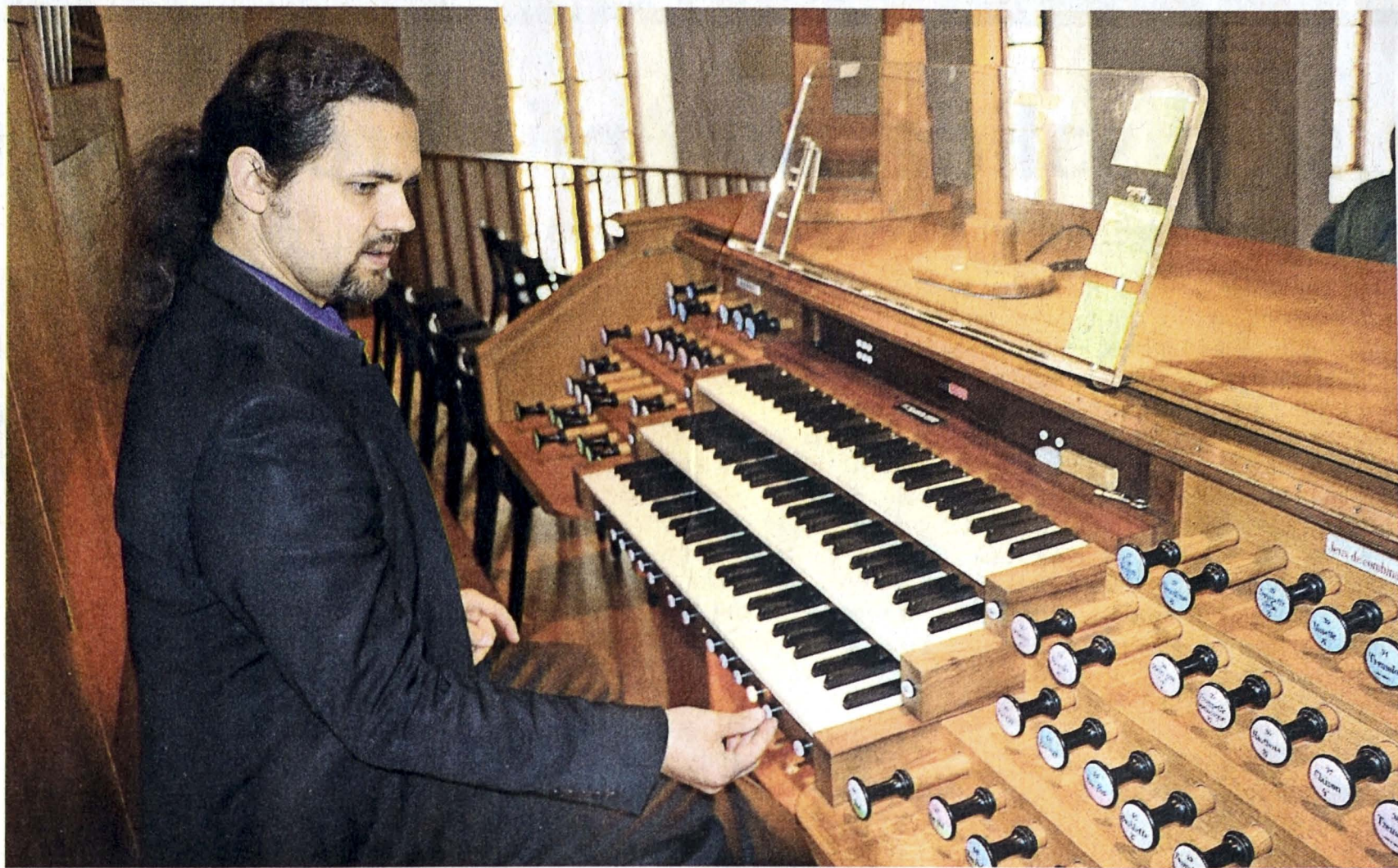
Der Organist drückt einen Knopf und die Register bewegen sich wie von Zauberhand: In der revidierten Liestaler Orgel verbindet sich Mechanik aus dem 19. Jahrhundert mit modernster Elektronik.
